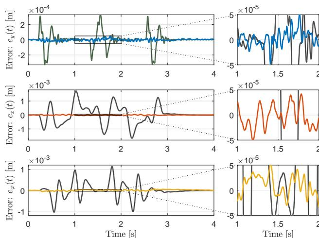
**Figure 2:** The initial error  $e_0(t)$  (—) and the final error  $e_{20}(t)$  for the  $y$  (—),  $x$  (—) and  $\phi$  axis (—).
